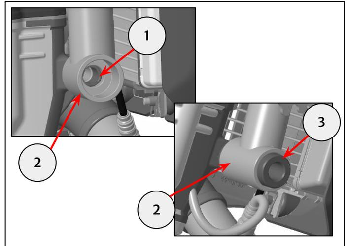
**11** Allineare il supporto inferiore del paramotore destro (1) alla staffa del paracolpi (2). Posizionare un distanziale da 10mm (3) fornito nel kit tra il paramotore e la staffa. Fissare il supporto inferiore con un dado (4) fornito nel kit.
