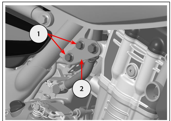
**9** Rimuovere la vite di serraggio anteriore destra del motore (1) e la rondella esterna (2); conservarle per il riutilizzo se la motocicletta deve essere riportata allo stato originale.
