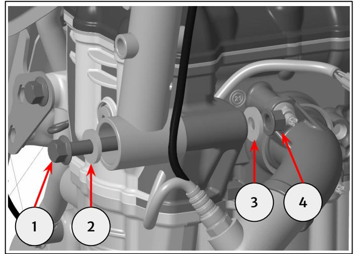
**10** Verificare che il regolatore (1) all'interno dell'incavo del telaio (2) sia serrato a **3 Nm**. Serrare se necessario. Nota: Richiede uno strumento specialistico per concessionarie.
