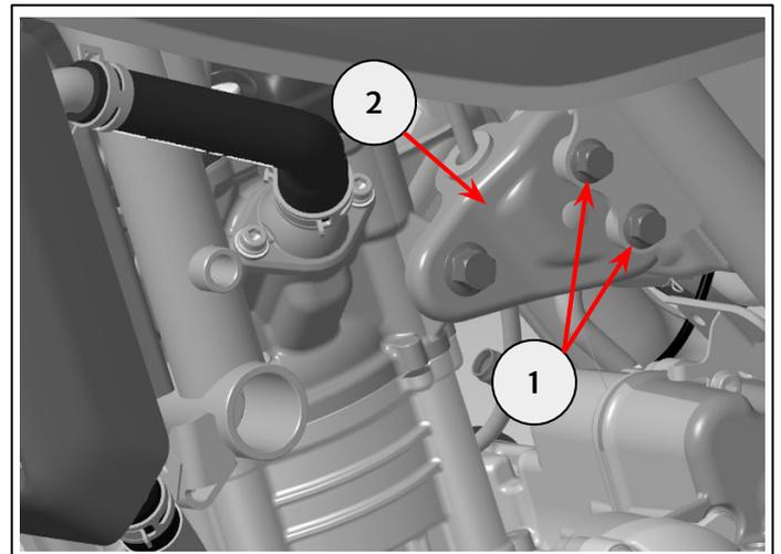
**4** Rimuovere la vite di serraggio anteriore sinistra del motore (1) e conservarla per il riutilizzo se la motocicletta deve essere riportata allo stato originale.
