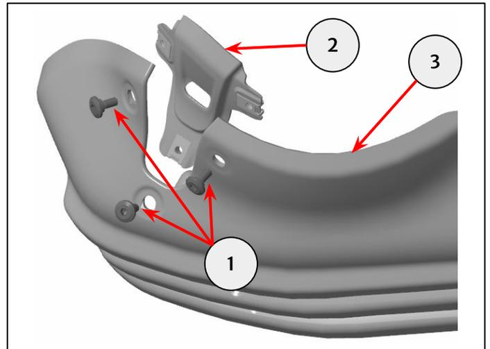
**16** Rimuovere i tre dadi con fermo (1) dal pannello di tamponamento (2) e trasferirli sul paracolpi (3) insieme alle viti (4) rimosse nel passaggio 15.
