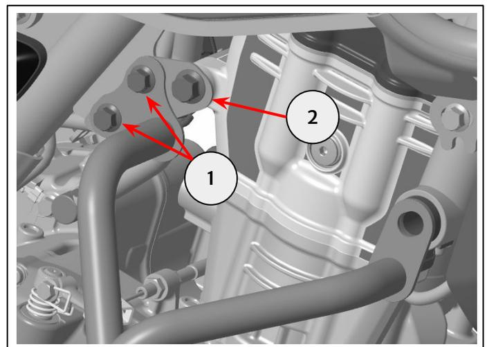
**13** Assemblare la vite M10 x 135mm (1) fornita nel kit insieme al dado (2) e alla rondella interna (3) precedentemente rimossa nel passaggio 9.
