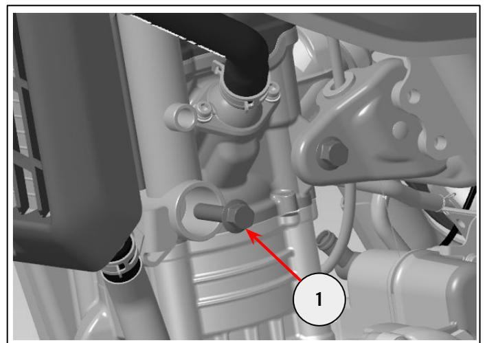
**5** Posizionare il distanziale da 46 mm (1) fornito nel kit nella scanalatura del telaio della motocicletta (2).
