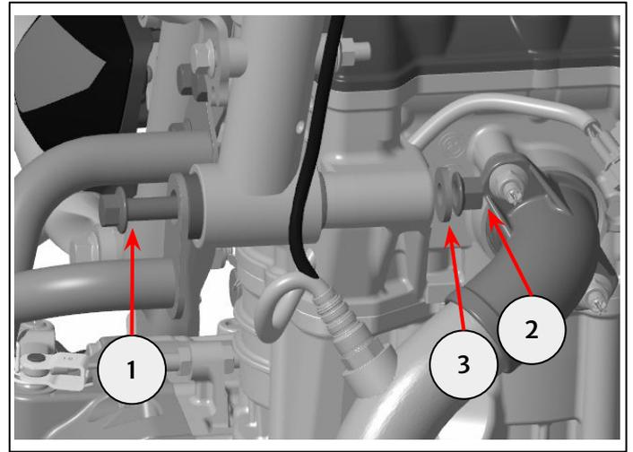
**14** Serrare la vite (1) attraverso la staffa del paracolpi (2) a **45 Nm**.
