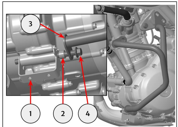
**7** Rimontare le viti M8 (1) precedentemente rimosse nel passaggio 3 per fissare il supporto paramotore posteriore (2) e serrare a 25 Nm.
