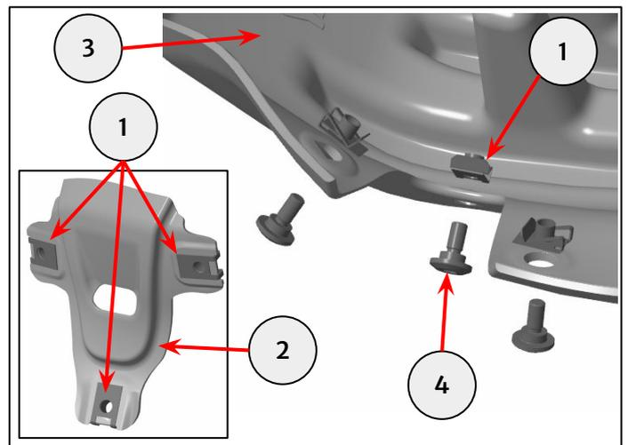
**17** Rimontare il paracolpi (1) facendo scorrere l'angolo posteriore sopra la staffa posteriore (2). Fissare il paracolpi alla staffa di montaggio anteriore utilizzando le viti originali (3) rimosse nel passaggio 1.
