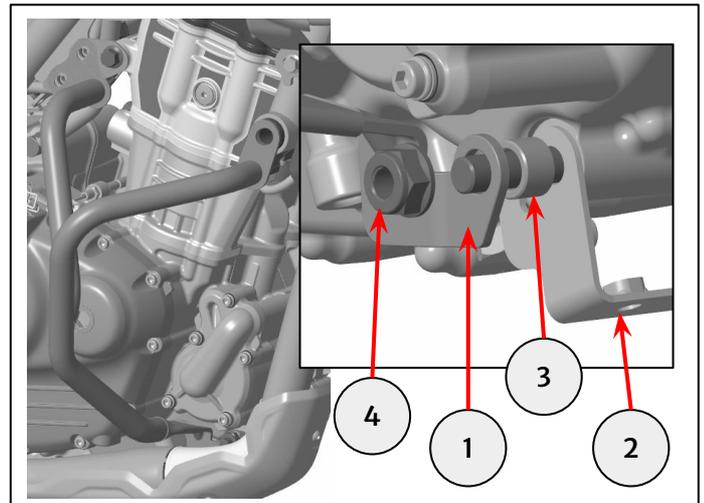
**12** Rimontare le viti M8 (1) precedentemente rimosse nel passaggio 8 per fissare il supporto paramotore posteriore (2).
