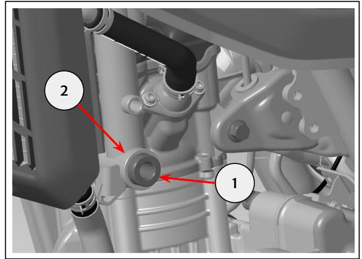
**6** Allineare il paramotore sinistro alla motocicletta come mostrato. Rimontare la staffa del paracolpi (1) precedentemente rimosso nel passaggio 2, posizionando un distanziale da 10 mm (2) fornito nel kit tra la staffa del paracolpi e il paramotore (3). Posizionare la vite M10 x 120 mm (4) fornita nel kit attraverso il foro di montaggio.
