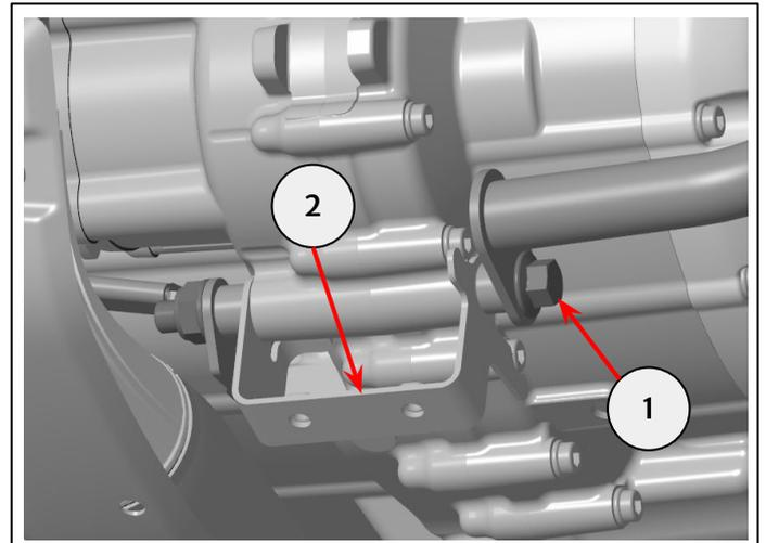
**15** Rimuovere le tre viti (1) che fissano il pannello di tamponamento (2) al paracolpi (3). Conservare viti e paracolpi per il riutilizzo, conservare il pannello di tamponamento per il riutilizzo se la motocicletta deve essere riportata allo stato originale.
