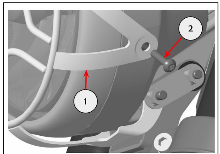
**5** Allineare l'angolo proiettore come descritto nel manuale e serrare le viti dell'attacco inferiore (1) a **10 Nm**.
