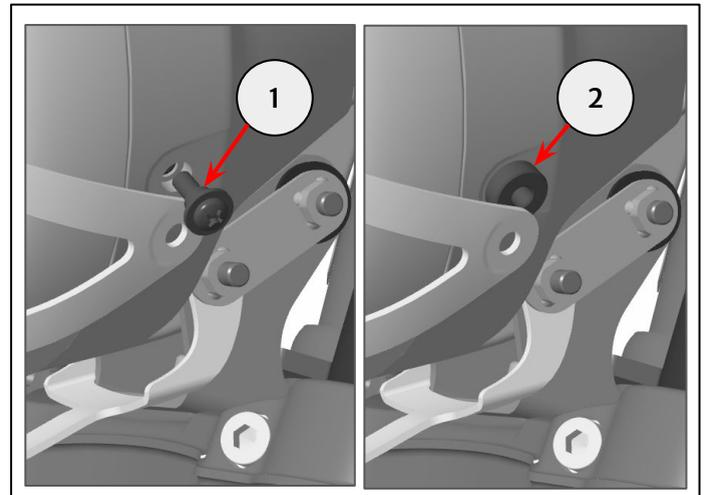
**4** Allineare la griglia proiettore (1) come mostrato. Fissare la griglia attraverso i supporti laterali con due viti M5 x 22 mm (2) fornite nel kit.
