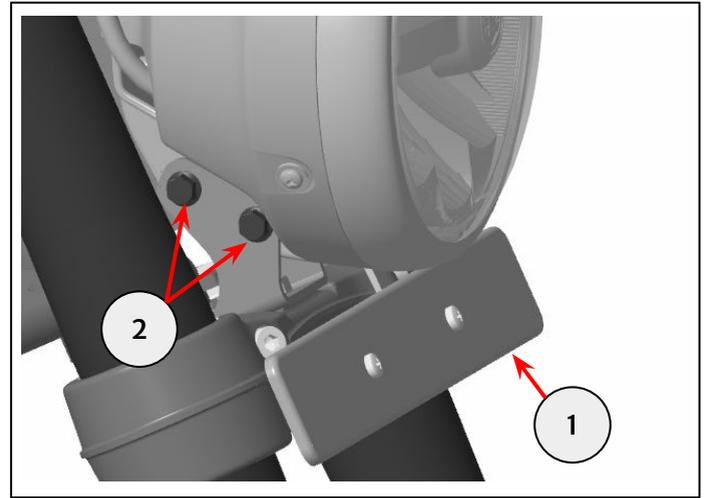
**2** Allineare la griglia proiettore (1) come mostrato. Fissare la griglia attraverso il supporto inferiore anteriore con una vite M6 x 70 mm (2) fornita nel kit sul dado con piastra precedentemente rimosso al passaggio 1.
